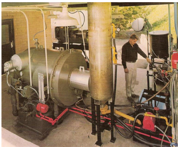
Рисунок 2.9 — Горизонтальный циклонный реактор для термического обезвреживания шламов [19]
